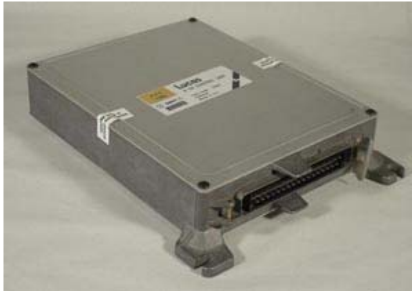
Figura 2. Una unidad de control electrónico (ECU) – con permiso de ‘Lucas Industries’.
