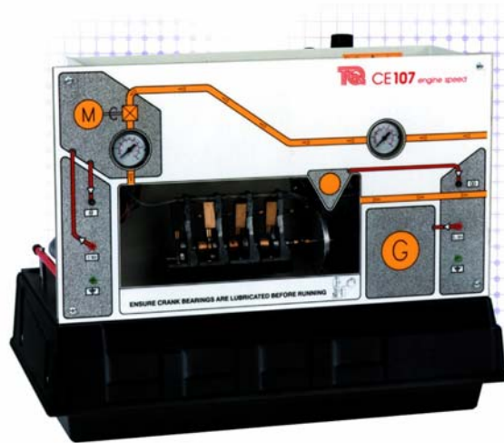
Figura 7. El TQ CE107, sistema estándar de control de la velocidad de un motor.
