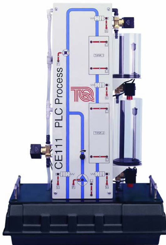
Figura 2. El proceso de PLC CE111.
