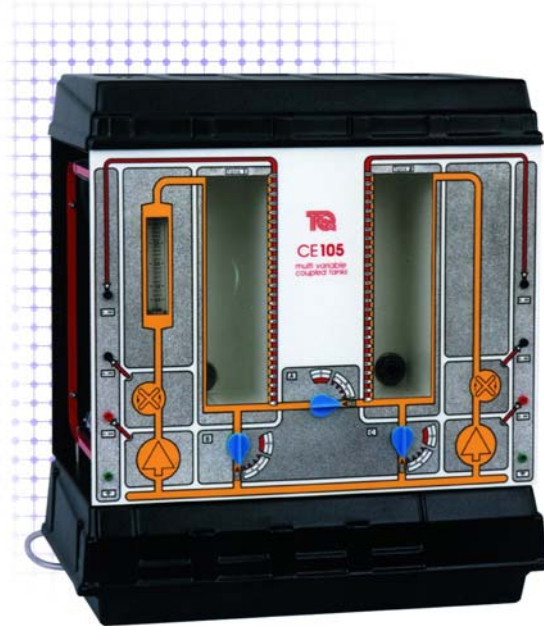
Figura 3. El sistema de tanques acoplados CE105
